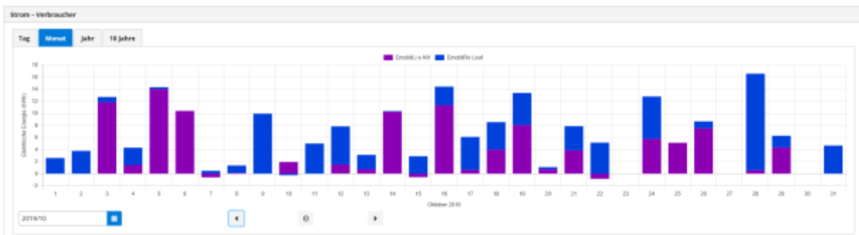
Abbildung 11: Tägliche Energiestatistik (kWh) der beiden Elektromobile (blau und magenta) über einen Monat, positive Werte für Ladevorgänge, negative Werte für Entladevorgänge, Beispiel 1.-31. Oktober 2019
